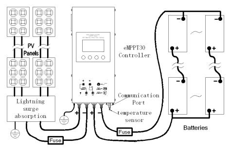
Figure4-2 System wiring diagram
