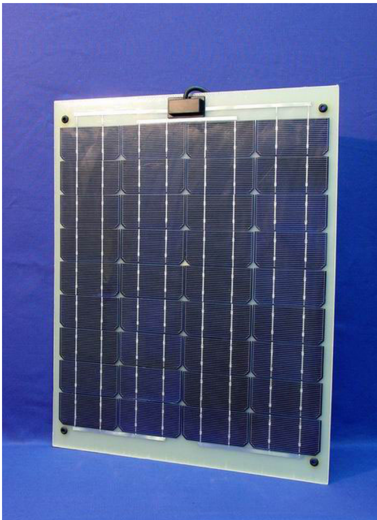
SLF25 : 25W, 12V, Mono-Crystal, Tedlar/EVA/Fibreglass
