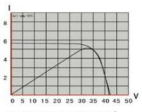
光照强度Irradiance:1000W/M<sup>2</sup> 组件温度Module temperature:25°C 大气质量Am1.5
