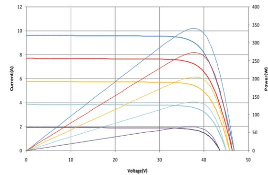
1000 W/m<sup>2</sup> 800 W/m<sup>2</sup> 600 W/m<sup>2</sup> 400 W/m<sup>2</sup> 200 W/m<sup>2</sup>
