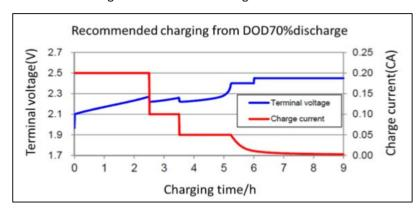
Maximum DOD: 70%DOD/30%SOC Recommended DOD: 50%DOD/50%SOC
