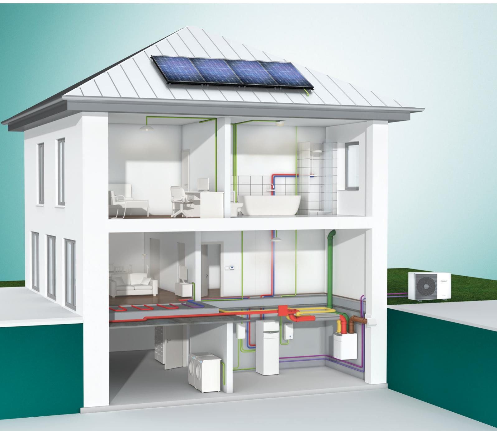
El objetivo es que la bomba de calor trabaje el mayor tiempo posible con energía renovable de origen fotovoltaico. Esta gestión de la energía térmica desplaza el consumo de energía requerido para climatización hacia las horas en las que el sistema fotovoltaico produce más energía, maximizando el autoconsumo y minimizando el vertido de electricidad en la red. **Un sistema perfecto para instalaciones tanto de obra nueva como rehabilitación con bomba de calor.**
