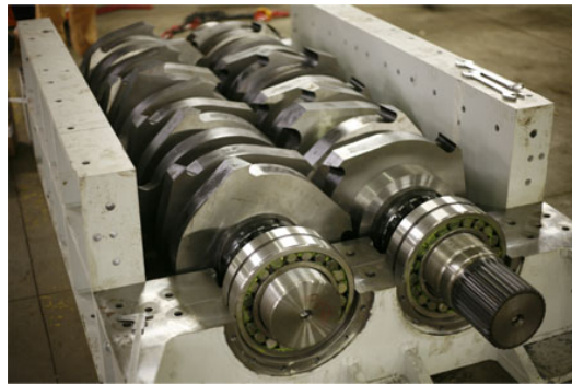
Accès facilité à la chambre afin d'extraire les deux arbres sans démontage des couteaux
